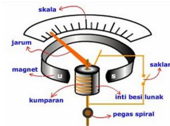
Gambar 3.1. Prinsip kerja alat ukur kumparan putar
